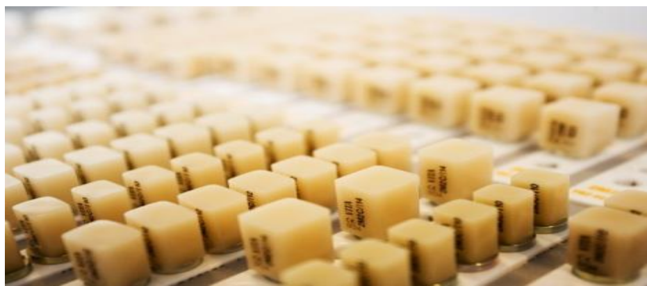
Slika 9. Keramički blokovi za glodanje u CAD-CAM glodavici. Preuzeto: (7)
