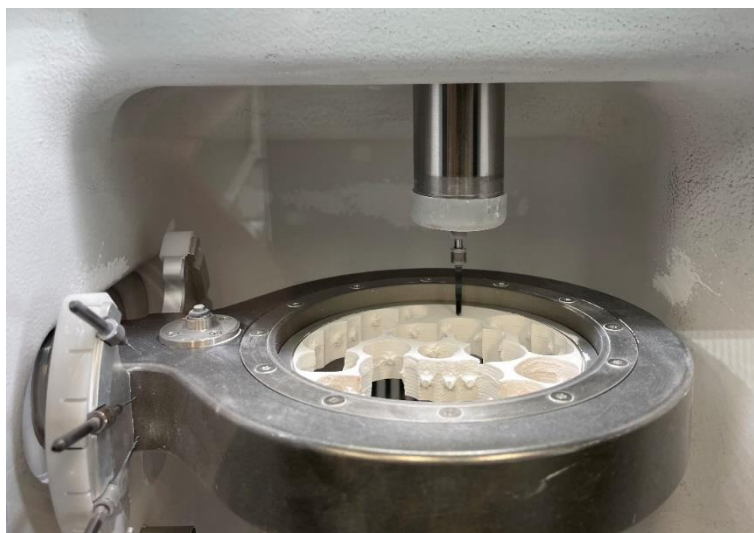
Slika 25. Proces suhog glodanja.
