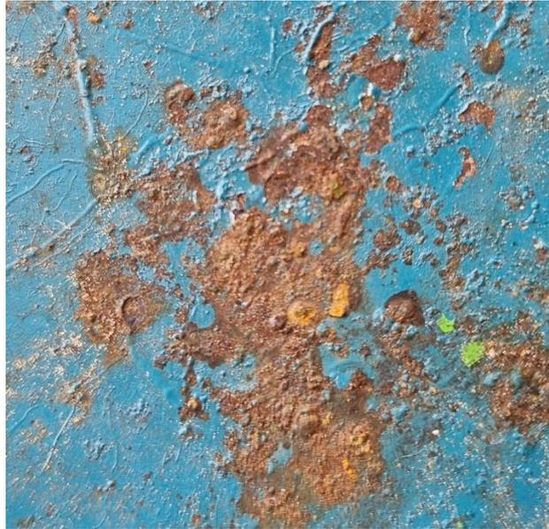
Slika 1. Taloženje površinskih oksida uslijed kemijskog korodiranja metala.
