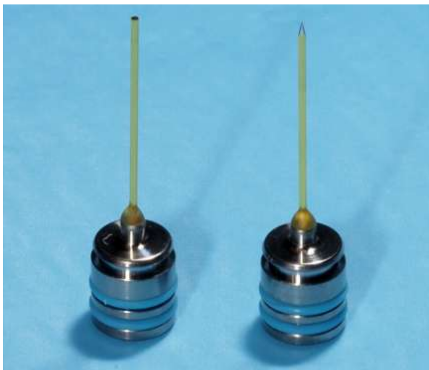
Slika 6. Ravni i konični SWEEPS nastavak (400 \mu\text{m} ) Zahvalnošću izv. prof. dr. sc. Ivona Bago
