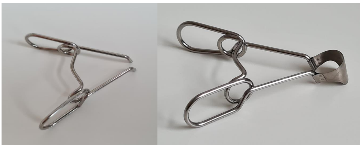
Slika 4. Nosač matrice s montiranom matricom
