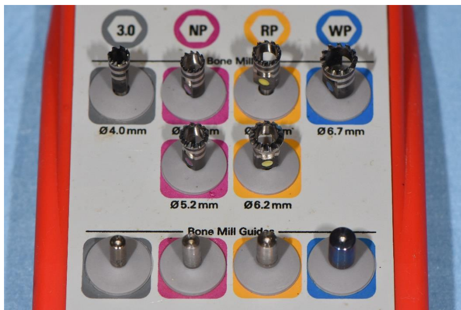
Slika 15. Set svrdala za oblikovanje koštanoga profila uz pripadajuće sigurnosne vodilice odgovarajućega promjera. Fotografirano i upotrijebljeno uz dopuštenje Poliklinike Identalia.
