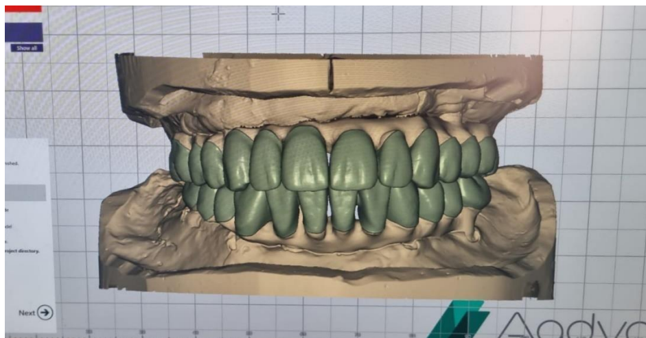
Slika 19. Postupak oblikovanja pojedinačnih krunica u programu Exocad.
