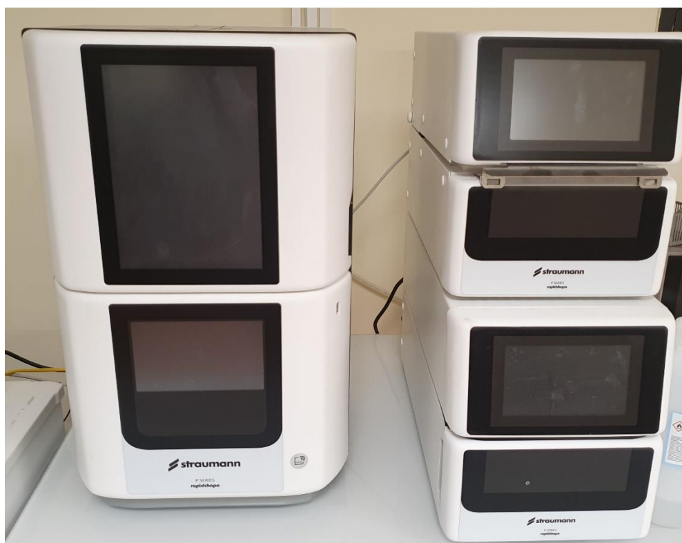
Slika 15. Straumann P20+ 3D printer
