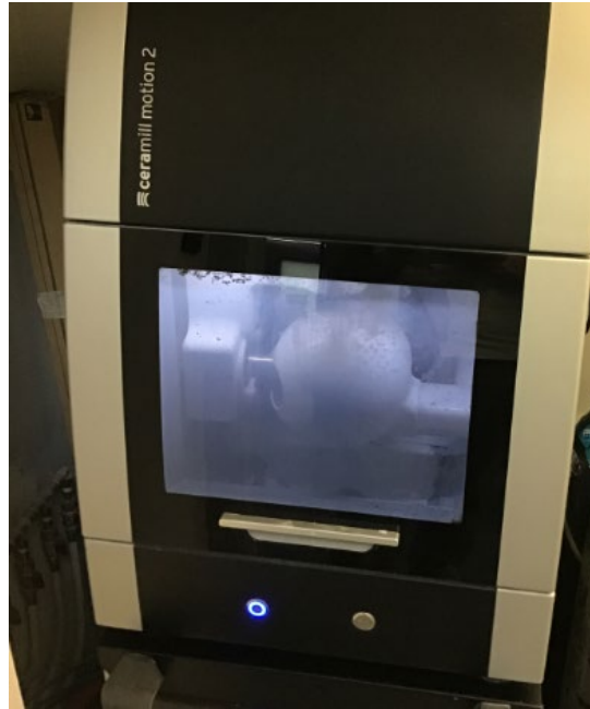
Slika 32. Glodanje cirkonij oksidnih kruna
