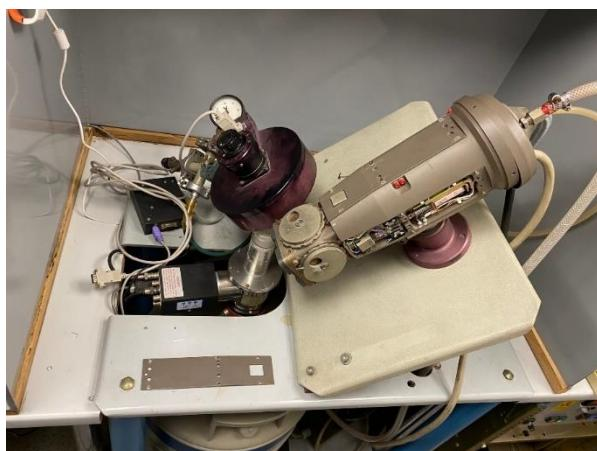
Slika 72 a. Uređaj za EDXRF analizu.
