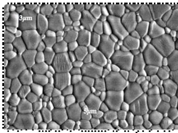
Slika 36. Mikrostruktura  $\text{Al}_2\text{O}_3$  keramike.
