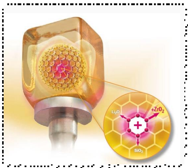
Slika 28. Shematski prikaz sastava litij-disilikatne staklokeramike ojačane cirkonij-dioksidom.
