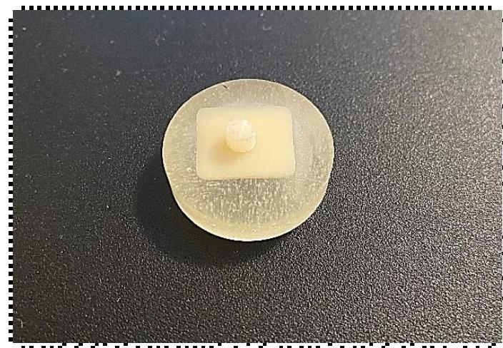
Slika 64. Uzorak s kompozitnim diskom promjera 3,5 mm.
