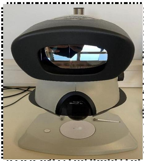
Slika 67. Stereomikroskop Mantis Elite-Cam HD.
