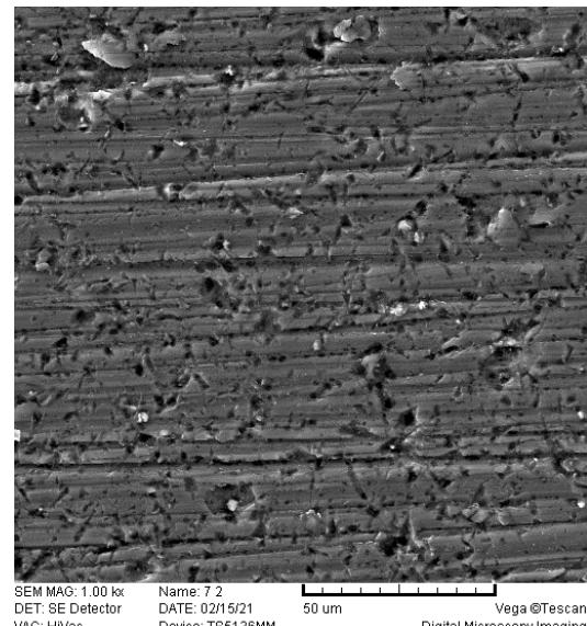
Slika 87 e. Topografija površine skupine tretirane pjeskarenjem.
