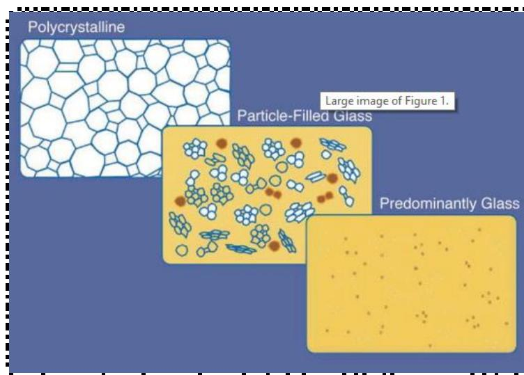
Slika 22. Shematski prikaz keramičkih materijala s obzirom na udio staklene faze.
