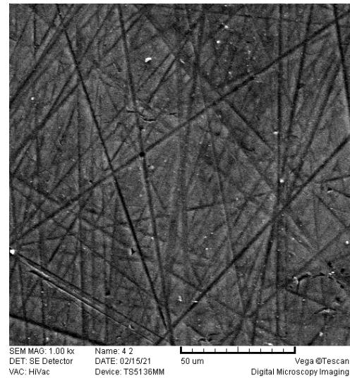
Slika 87 b. Topografija površine skupine tretirane fluorovodičnom kiselinom.
