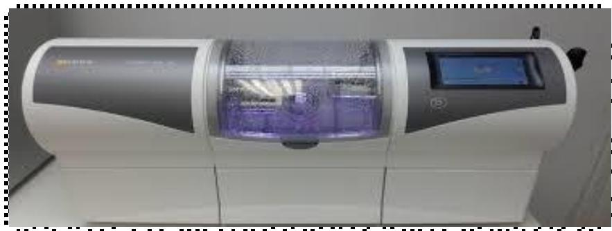
Slika 17. CAM jedinica – glodalica.
