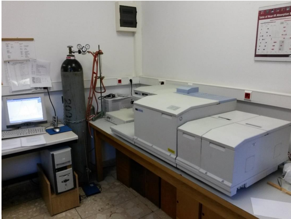
Slika 23. FT-Raman spektrometar Spectrum GX na Zavodu za fiziku Medicinskog fakulteta Sveučilišta u Zagrebu.
