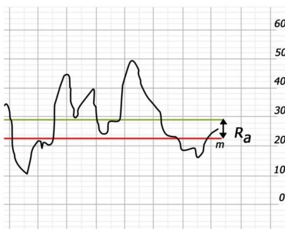
Slika 16. R_a – srednje aritmetičko odstupanje profila. [Osnovni koncept ilustracije preuzet iz (58). Individualizirao i uredio autor.]
