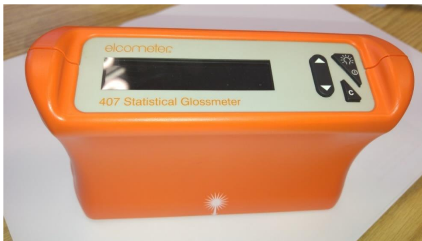
Slika 58. Uređaj za mjerenje sjaja površine Elcometer.
