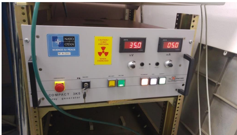
Slika 48. Parametri zračenja: napon 35 kV, jačina struje 5 mA.
