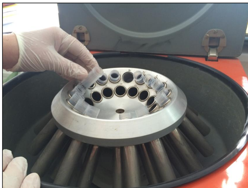
Slika 18. Postavljanje epruveta u centrifugu (Tehtnica, Železniki, Slovenija)
