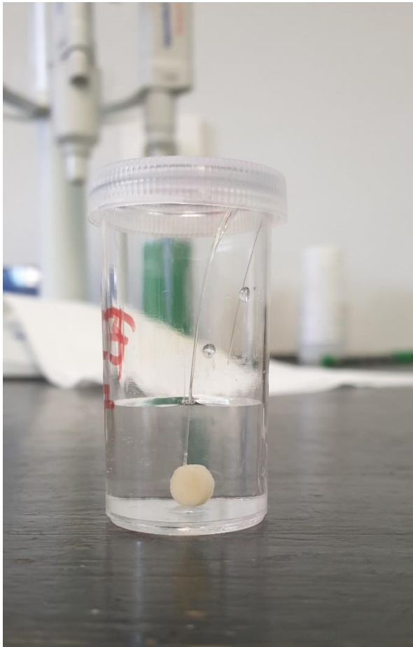
Slika 2. Uzorak restaurativnog materijala pohranjen u 5 ml deionizirane vode
