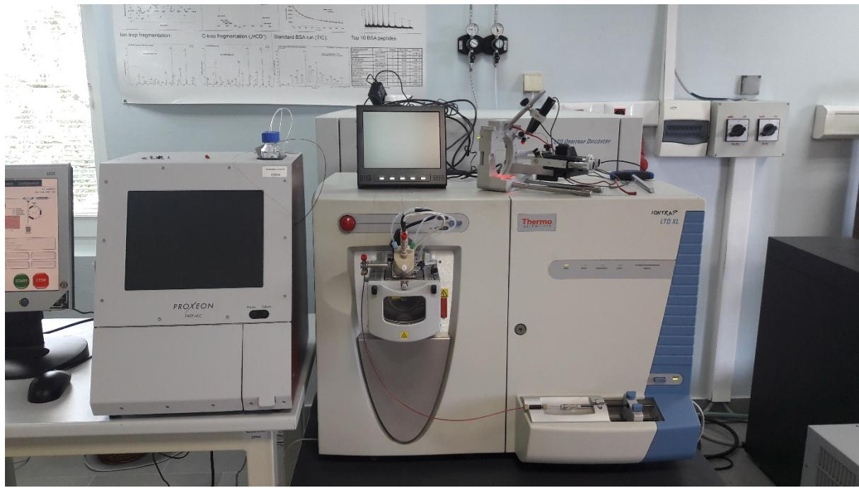
Slika 15. Tekućinska kromatografija i masena spektrometrija
