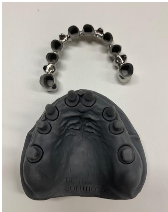
Slika 4. Metalna osnova mosta i radni model ispisani 3D tehnologijom. Preuzeto s dopuštanjem autora: izv. prof. dr. sc. Nikša Dulčić
