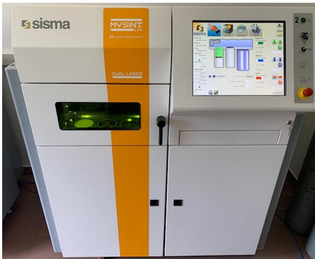
Slika 1. Uređaj za lasersko taljenje. Preuzeto s dopuštenjem autora: izv. prof. dr. sc. Nikša Dulčić
