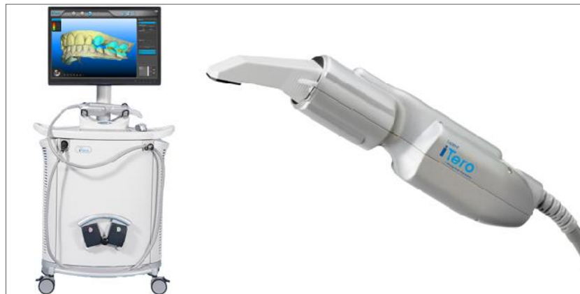
Slika 8. iTero intraoralni dentalni skener. Preuzeto iz: (20)
