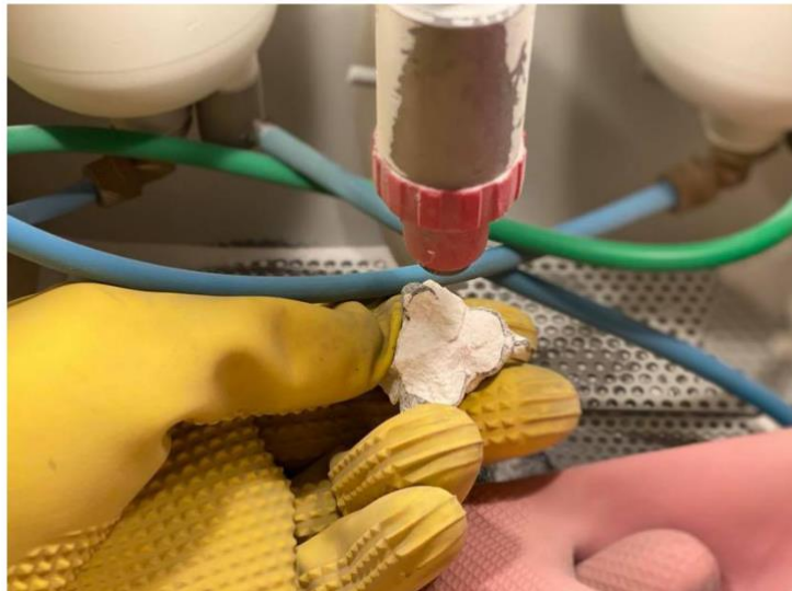
Slika 5. Pjeskarenje fiksnoprotetskog odljeva.
