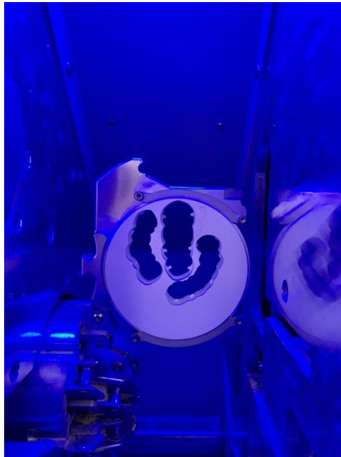
Slika 2. Blok cirkonij-oksidne keramike u glodalici
