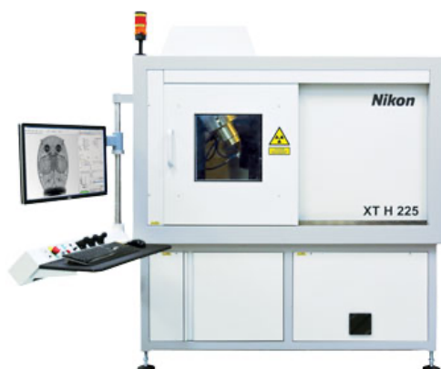
Slika 5. NIKON XT-H 225 (Nikon Corporation, Tokio, Japan), uređaj kojim su skenirani uzorci.
