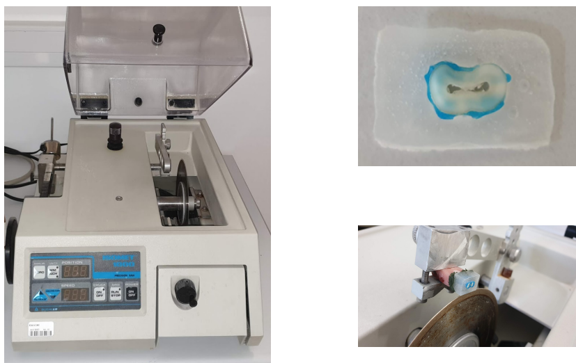
Slika 9. Isomet 1000 (Buehler, Lake Bluff, IL, SAD) precizna pila, koronarni dio prezanog uzorka i postupak rezanja.
