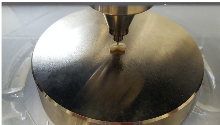
Slika 12. Uzorak u univerzalnom uređaju za testiranje neposredno prije primjene sile za testiranje čvrstoće uzorka.
