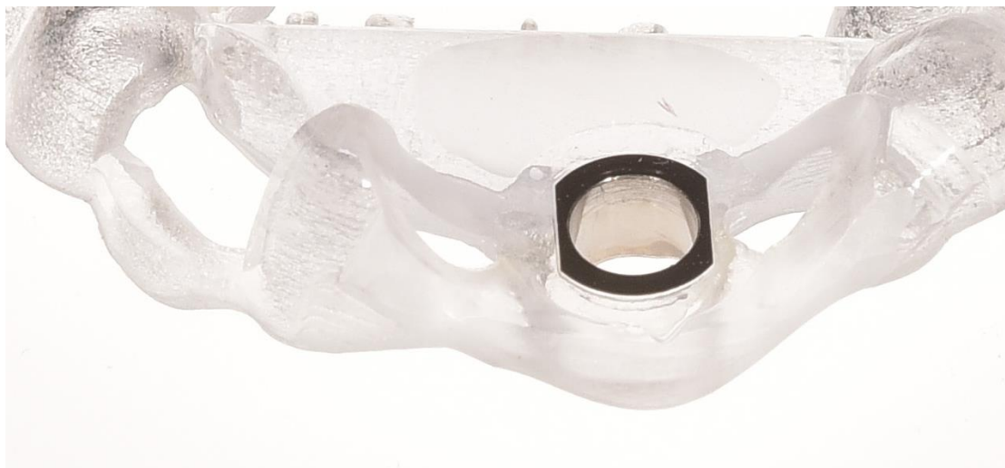
Slika 15. Prozorčići za kontrolu dosjeda i metalni prsten unutar kirurške vodilice.
