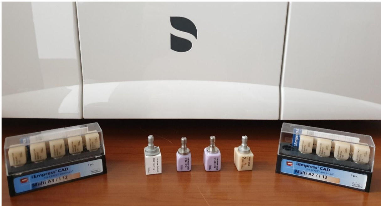
Slika 4. Blokovi materijala za glodalicu. Preuzeto s dopuštenjem autora: prof.dr.sc. Zoran Kovač
