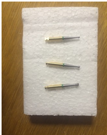
Slika 29. Karbidna svrdla veličine 1,0/1,6/2,3 mm
