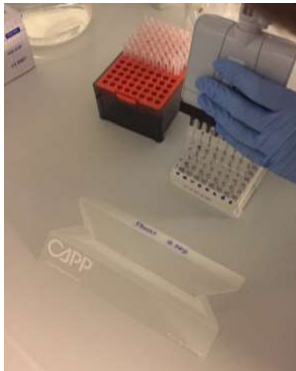
Slika 16. Prikaz pipetiranja uzoraka pomoću multikanalne pipete u ELISA pločicu
