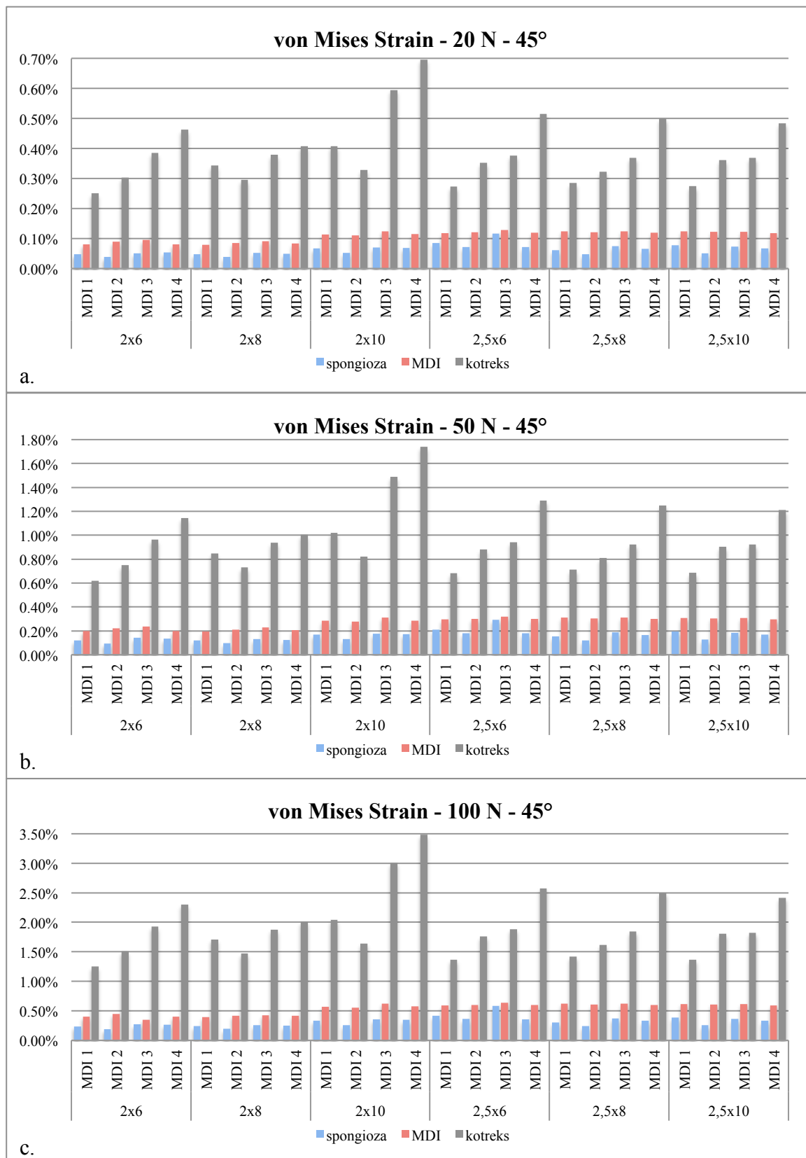
Slika 35. Grafički prikaz iznosa maksimalnih naprežanja (von Mises Strain) kod aksijalnog opterećenja na površini mini dentalnog implantata i na kontaktnoj površini spongioze i korteksa: a. 20 N; b. 50 N; c. 100 N
