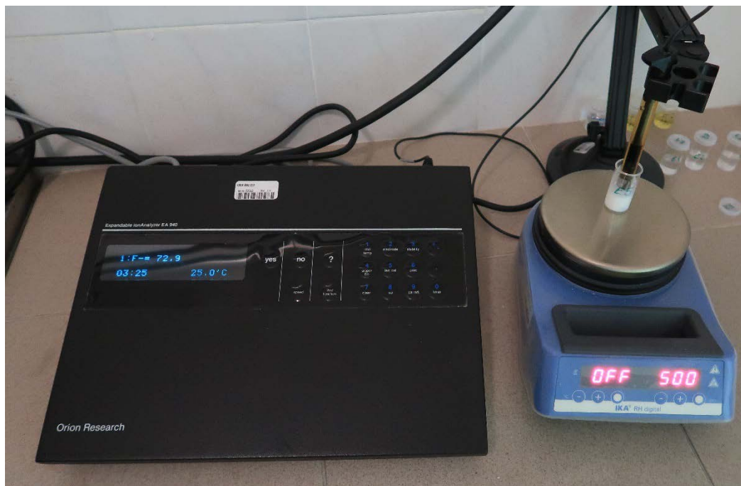
Slika 3. Aparatura za mjerenje (slijeva nadesno: ionski analizator, magnetska miješalica, fluorid selektivna elektroda uronjena u otopinu).
