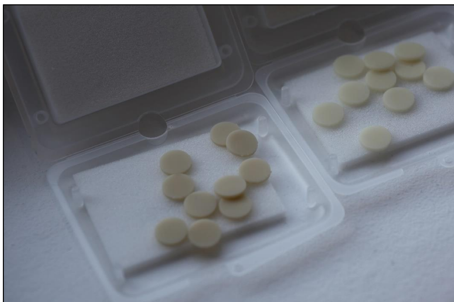
Slika 3. MMA uzorci izrađeni tehnologijom 3D printanja
