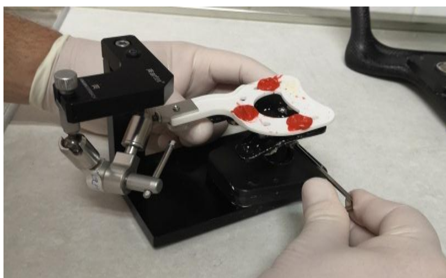
Slika 7. Zatezanje vijkom donjeg dijela prijenosnog postolja.
