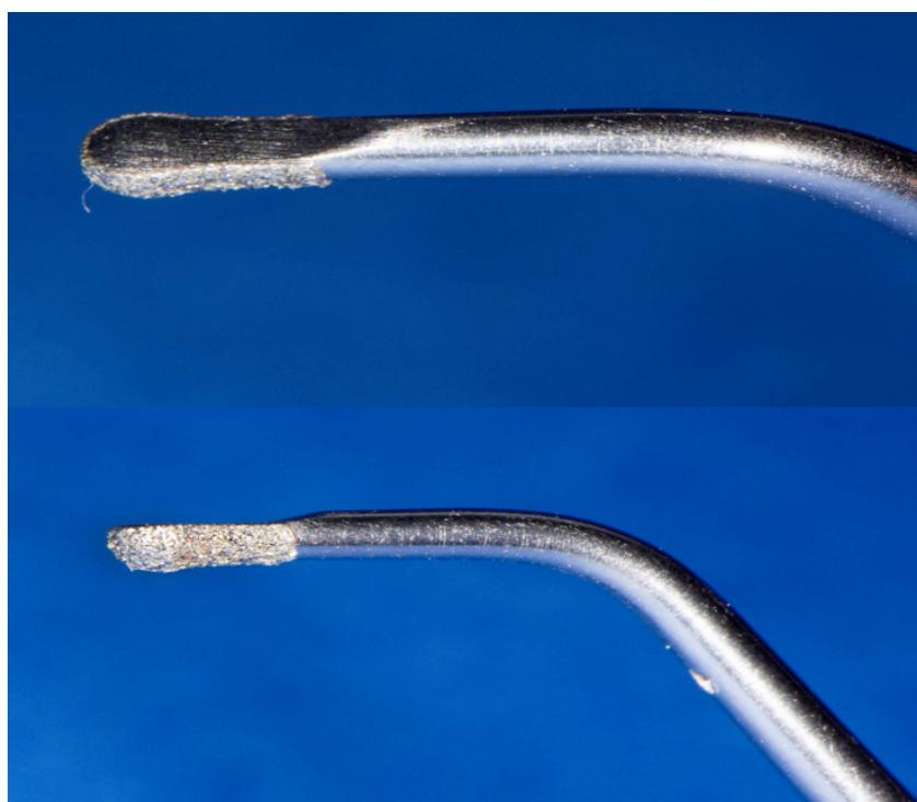
Slika 10. Oscilirajuće dijamantno svrdlo (aktivni i neaktivni dio)
