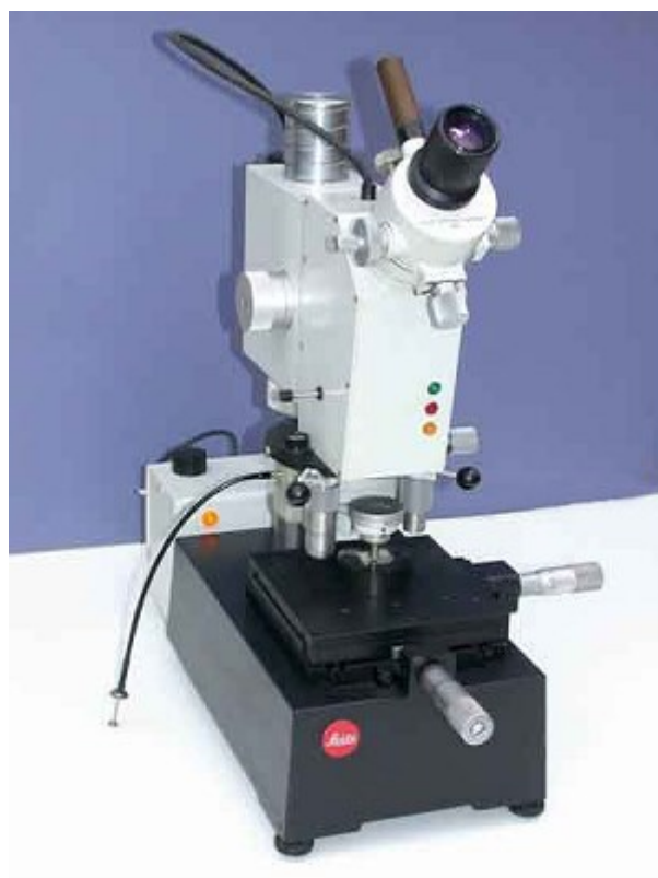
Slika 11. Uređaj Leitz Miniload 2 Microhardness Tester
