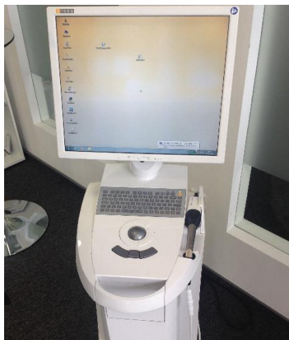
Slika 2. Skener i računalo CAD/CAM tehnologije. Preuzeto s dopuštenjem autora: doc. dr. sc. Andreja Carek.
