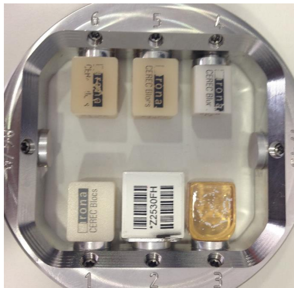
Slika 9. Keramički blokovi za glodanje. Preuzeto s dopuštenje autor: doc. dr. sc. Andreja Carek.
