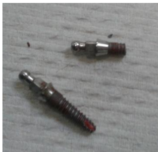
Slika 14. Puknuti mini dentalni implantat. Preuzeto s dopuštenjem autora: doc. dr. sc. Sanja Peršić Kiršić.
