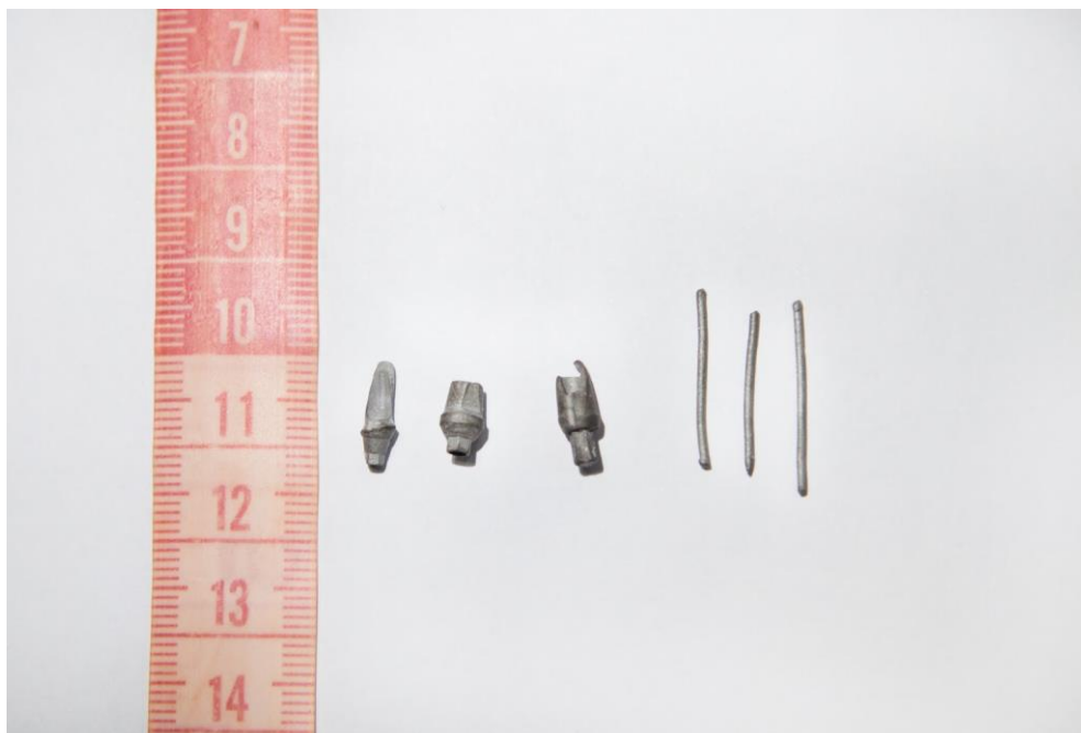
Slika 1. Ti - elektroda (titanski abutmenti) i Co – Cr - elektroda
