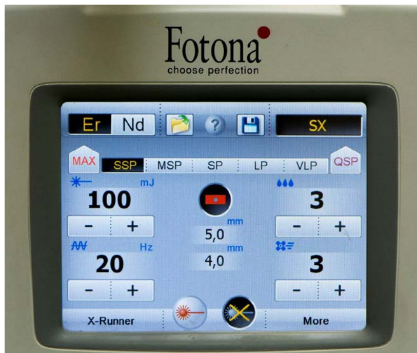
Slika 6. Prikaz zaslona pri SSP operacijskom modu lasera
