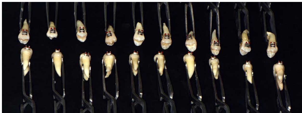
Slika 11. Uzorak pripremljen za termocikliranje
