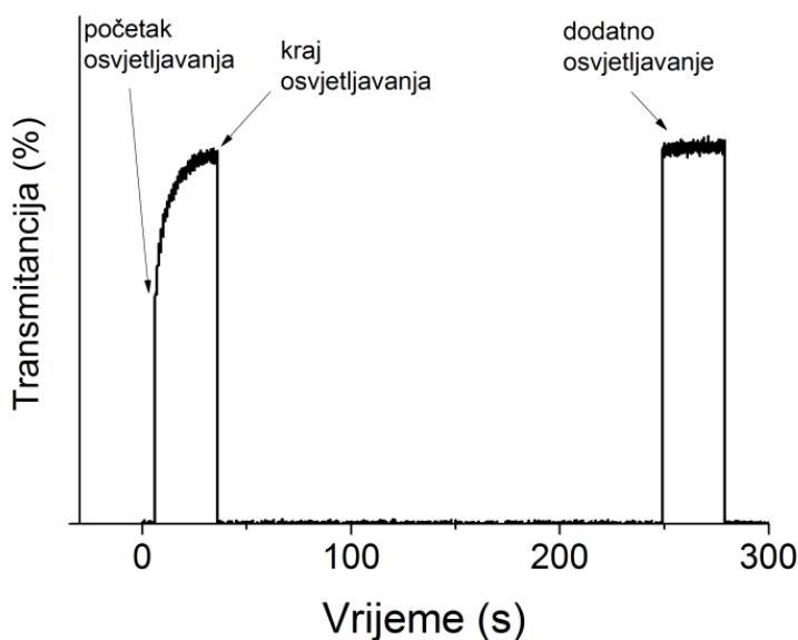
Slika 29. Reprezentativna krivulja svjetlosne transmitancije (materijal BG-10) snimljena u stvarnom vremenu tijekom svjetlosne aktivacije polimerizacije od 30 s i naknadnog osvjetljavanja od 30 s
