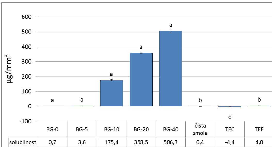
Slika 40. Apsorpcija vode i solubilnost izražene u  $\mu\text{g}/\text{mm}^3$ . Stupci pogrešaka predstavljaju  $\pm 1 \text{ s.d.}$
