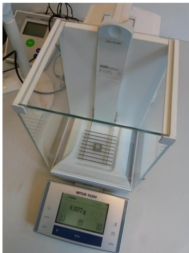
Slika 12. Analitička vaga s preciznošću mjerena od 0,1 mg (XS204, Mettler Toledo)
