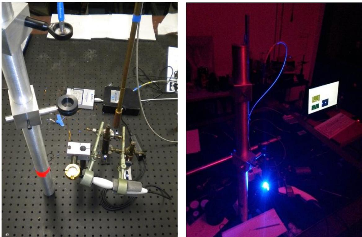
Slika 10. Eksperimentalni postav za mjerene transmisije svjetlosti kroz kompozitni materijal (lijevo). Eksperiment se izvodi u mraku kako pozadinsko osvjetljenje ne bi ometalo mjerene (desno).
