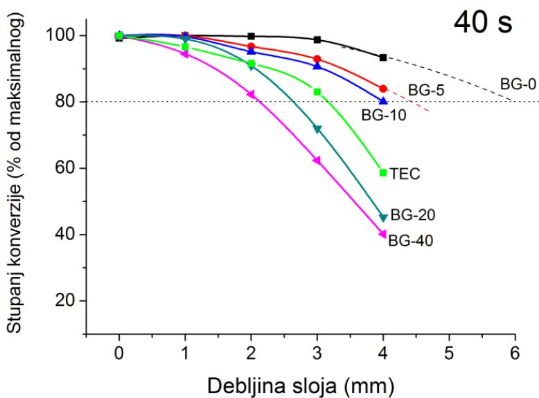
Slika 28. Krivulje smanjenja DC-a s porastom debljine kompozitnog sloja. Dubina na kojoj DC iznosi 80 % od maksimalne vrijednosti smatra se dubinom polimerizacije. Tijekom osvjetljavanja od 40 s vrijednosti dubine polimerizacije materijala BG-0 i BG-5 bile su više od raspona u kojem su izvršena mjerena (4 mm), stoga su odgovarajuće krivulje prilagođene na polinom drugog reda kako bi se ekstrapolacijom aproksimirala dubina polimerizacije (isprekidane linije).
