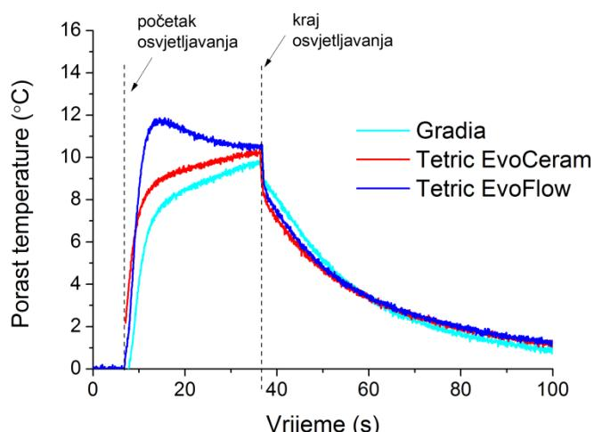
Slika 35. Uvećani prikaz početnog dijela temperaturnih krivulja (tijekom prvog osvjetljavanja) kod eksperimentalnih kompozita i komercijalnih kompozita
