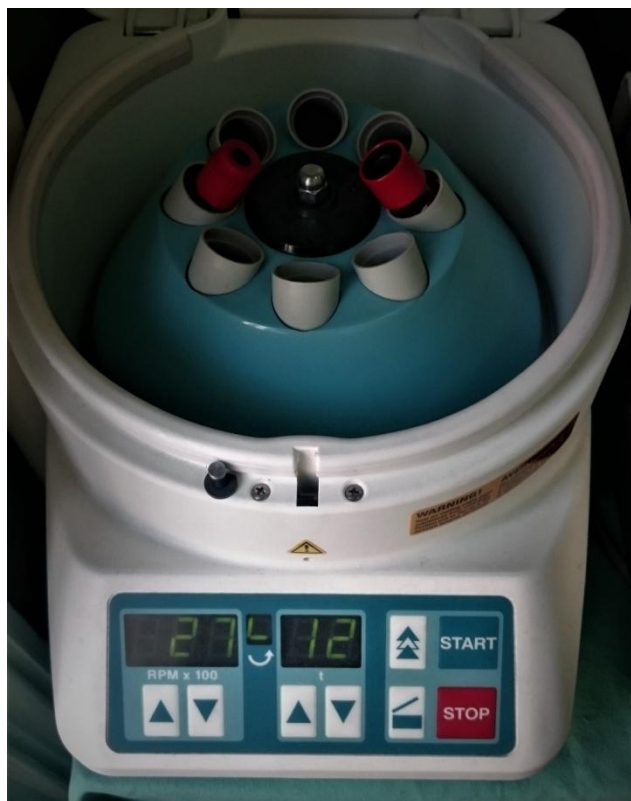
Slika 1. Postavljanje dviju epruveta s venskom krvi u centrifugu (12 minuta, 2700 rpm). Preuzeto s dopuštanjem autora doc.dr.sc.Ivana Puhara.
