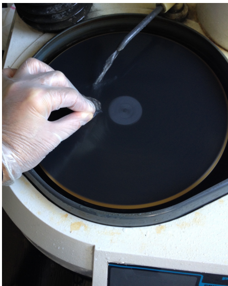
Slika 12 Poliranje uzoraka na stroju za poliranje Phoenix Alpha, “Buehler”, SAD pomoću SiC brusnog papira pod mlazom vode u Laboratoriju za materijalografiju, Fakulteta strojarstva i brodogradnje Sveučilišta u Zagrebu, Hrvatska.
