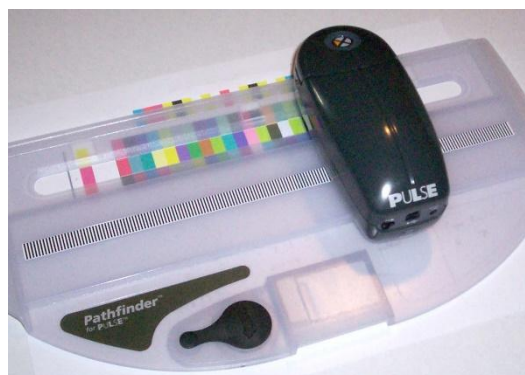
Slika 67. Spektrofotometar DTP 20 Pulse, X-Rite
