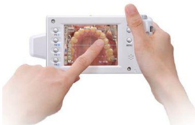
Slika 47. EyeSpecial C-II Digital Dental Camera, Shofu, Kyoto, Japan (preuzeto iz 179)
