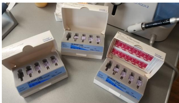
Slika 62. Presinterirani blokovi za strojnu izradu
