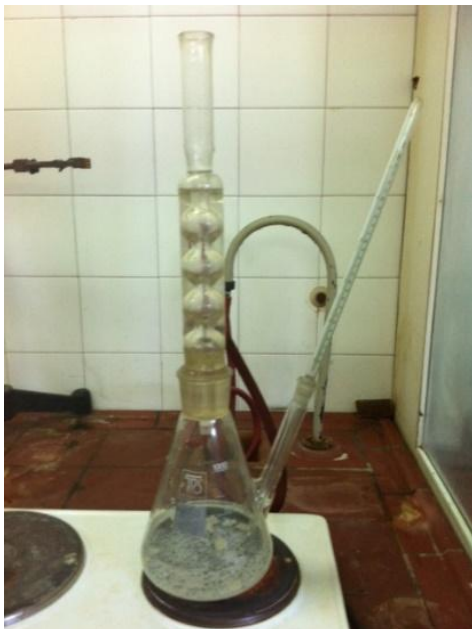
Slika 70. Aparatura u kojoj je proveden postupak nagrizanja uzoraka zubnih keramika sukladno ISO normi
