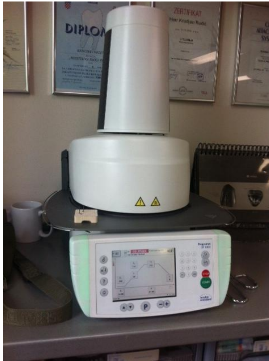
Slika 57. Peć za pečenje keramičkih nadomjestaka
