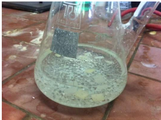
Slika 69. Ulaganje uzoraka zubnih keramika u 4% otopinu octene kiseline
