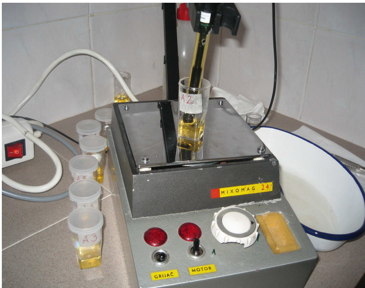
Slika 13. Mjerenje ion - selektivnom elektrodom
