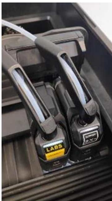
Slika 4. MakerBot Labs Gen 2 sapnica za ekstruziju filameta od polilaktične kiseline (PLA).
