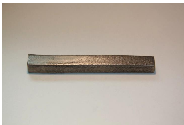
Slika 31. Prikaz jedne od triju šipki dobivenih postupcima metalurgije praha
