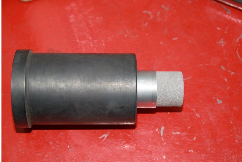
Slika 29. Uzorak titana izvađen iz kivete nakon CIP postupka
