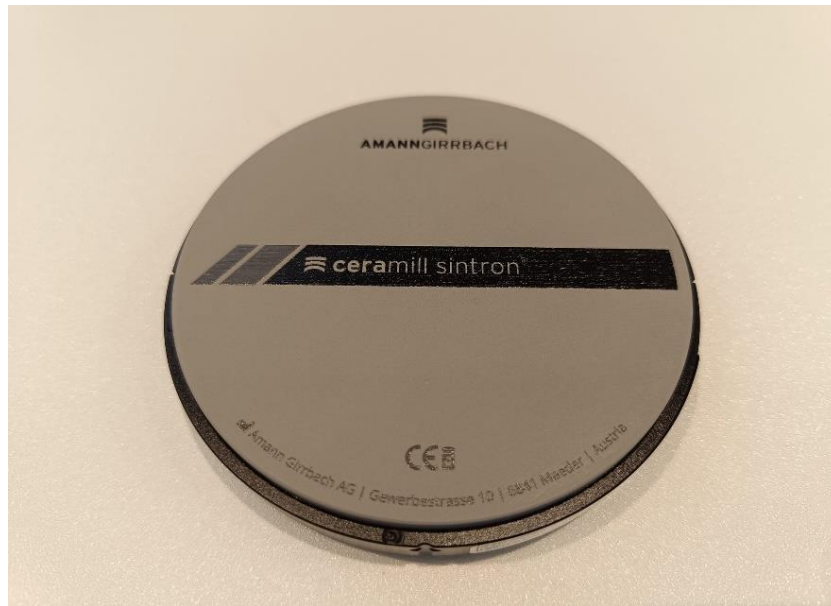
Slika 9. Disk kobalt-krom legure prije postupka glodanja
