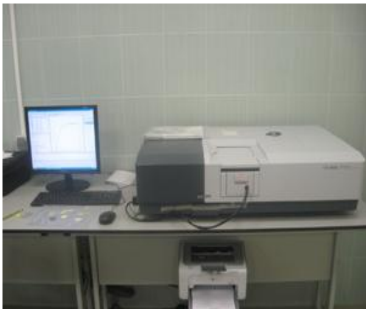
Slika 29. UV/VIS NIR spektrofotometar (3600, Shimadzu, Japan).
