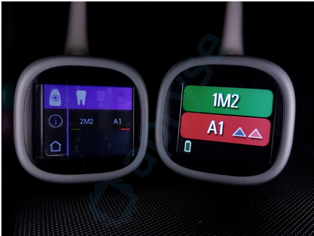
Slika 17. Usporedba rezultata mjerenja boje zuba 21 VITA Easyshade V (lijevo) i VITA Easyshade LITE (desno) spektrofotometrom
