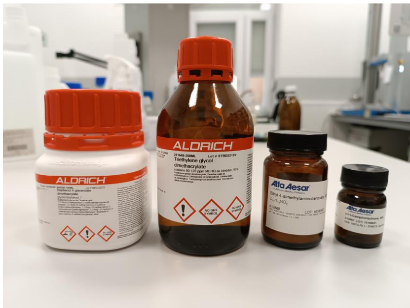
Slika 1. Metakrilatne smole i sustav fotoinicijatora za pripremu eksperimentalnih kompozitnih materijala. S lijeva na desno: Bis-GMA, TEGDMA, kamforkinon, etil-4-dimetilaminobenzoat.
