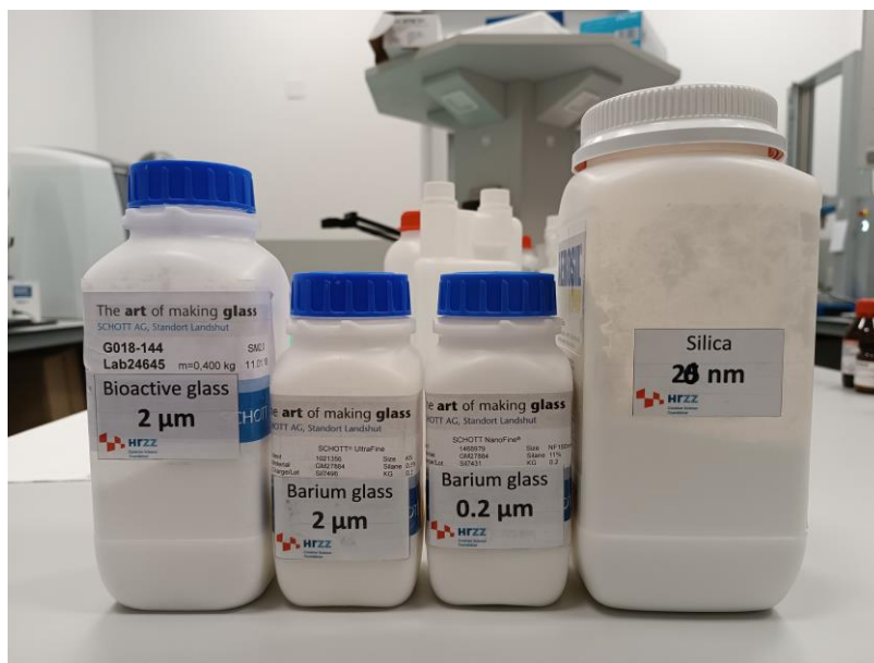
Slika 2. Punila za pripremu eksperimentalnih kompozitnih materijala. S lijeva na desno: bioaktivno staklo, barijevo staklo dimenzija čestica 2 mikrometra, barijevo staklo dimenzija čestica 0,2 mikrometra, silika (pirogeni SiO 2 ).
