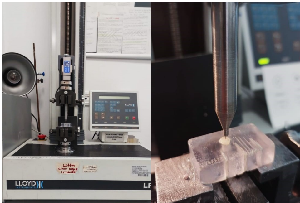
Slika 8. Prikaz uređaja korištenog za provođenje „push out“ testa i način primjene opterećenja na ispitivani uzorak.
