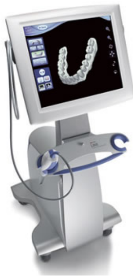
Slika 8. Lava COS intraoralni dentalni skener. Preuzeto iz: (36)
