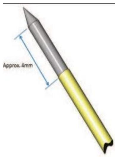
**Slika 5.** Shematski prikaz radijalnog „*Stripped*“ laserskog nastavka
