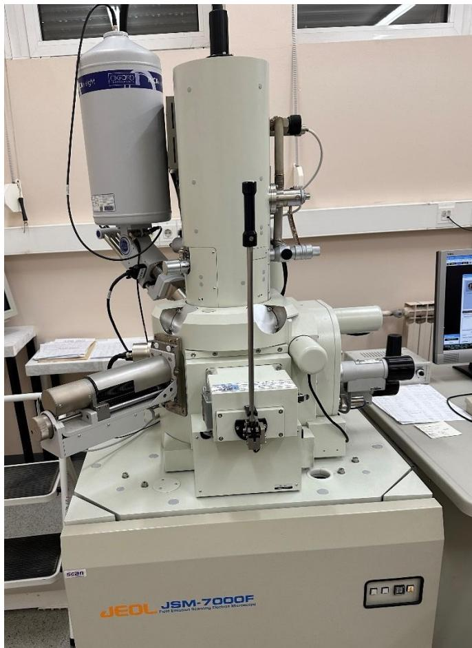
**Slika 34.** Pregledni elektronski mikroskop (JEOL JSM-7000F)
