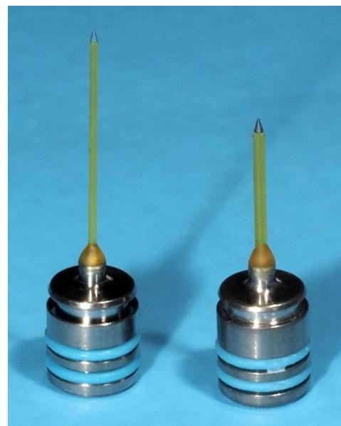
**Slika 7.** Različit dizajn laserskih nastavaka za Er:YAG lasersku aktivaciju irigansa uz korištenje SWEEPS modaliteta (Fotona, Ljubljana, Slovenija): radijalni nastavak promjera 400  $\mu\text{m}$ , duljine 12 mm; radijalni nastavak promjer promjera 600  $\mu\text{m}$ , duljine 9mm.
