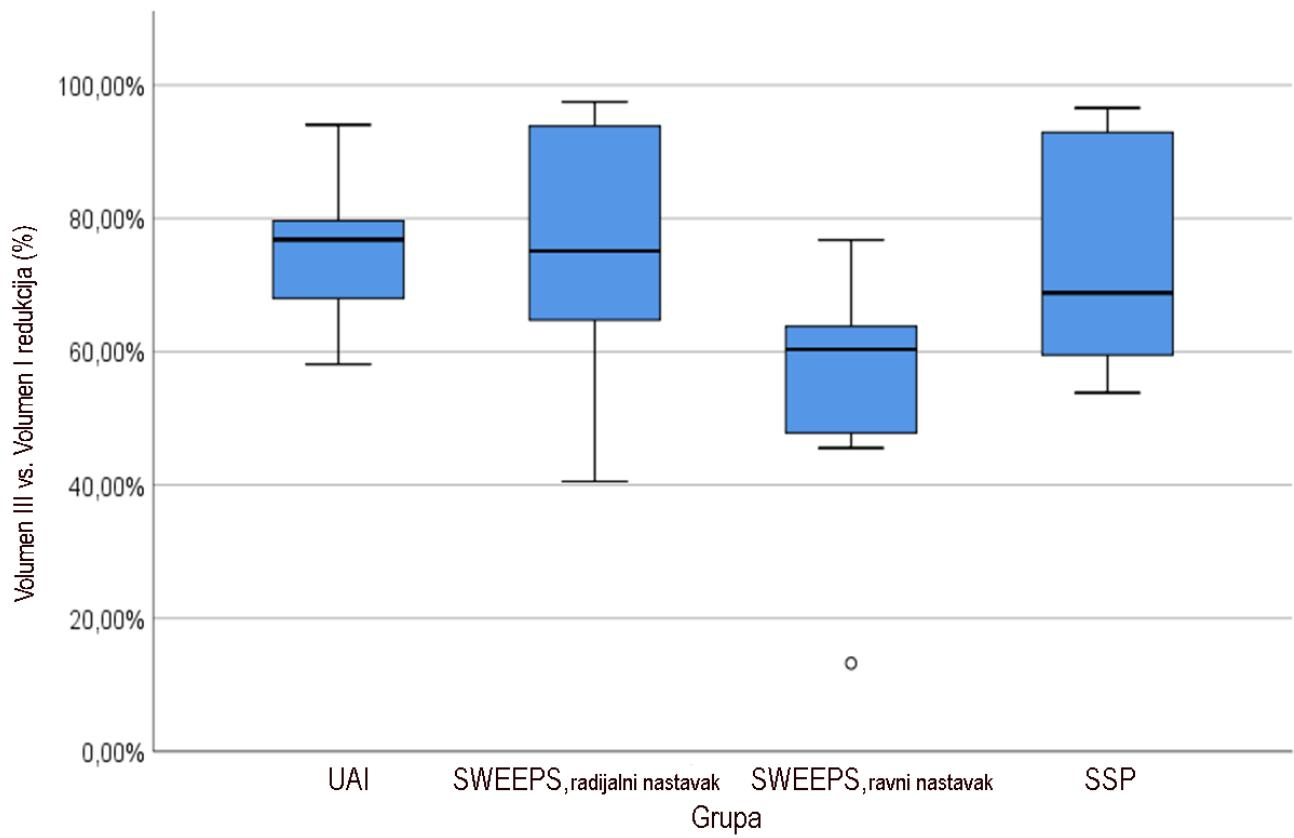
**Slika 38.** Grafički prikaz stupnja smanjenja materijala za punjenje nakon završnog protokola ispiranja (Volumen III) u usporedbi s početnim volumenom nakon punjenja kanala (Volumen I); UAI- ultrazvučno aktivirano ispiranje, SSP- *Super short pulse*, SWEEPS- *Schock wave enhanced emission photoacoustic streaming*
