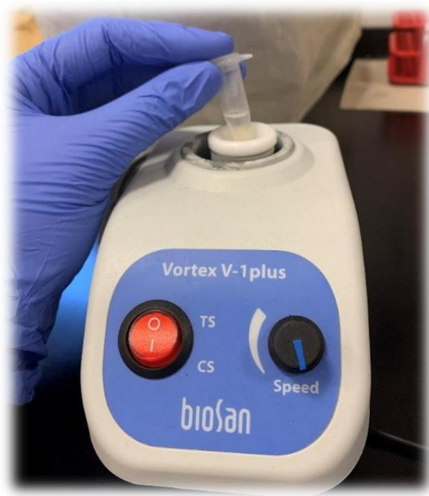
**Slika 31.** Vorteksiranje dentinskih diskova s ciljem dobivanja suspenzije s preostalim prisutnim bakterijskim biofilmom nakon eksperimentalnog ispiranja uzorka
