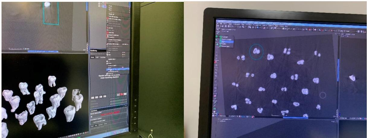
**Slika 19.** Obrada rezultata i mjerjenje volumena materijala za punjenje (inkluzija) u softveru mikro-CT uređaja
