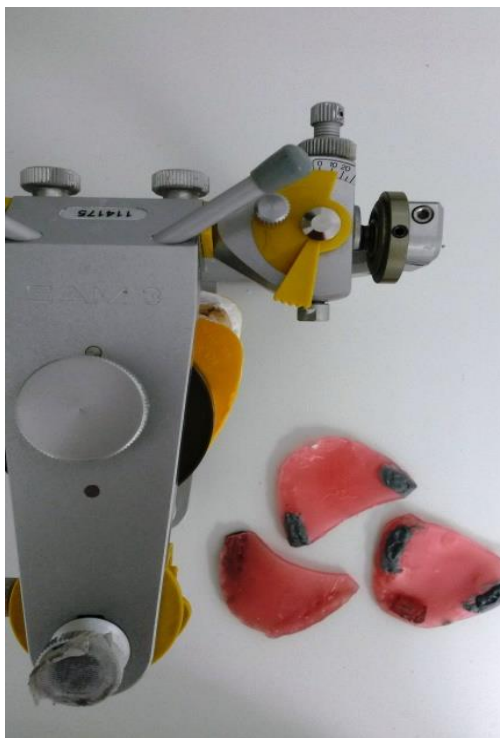
Slika 3. Prikaz ekscentričnih voštanih registrata i zglobnog mehanizma artikulatora SAM 3 (vrijednost Bennettova kuta)
