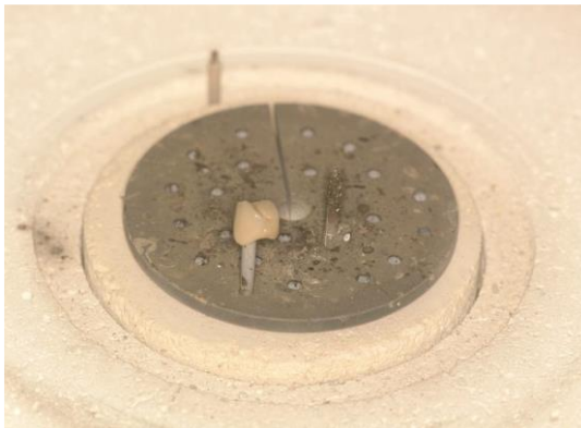
Slika 24. Metal-keramički objekt na postolju peći
